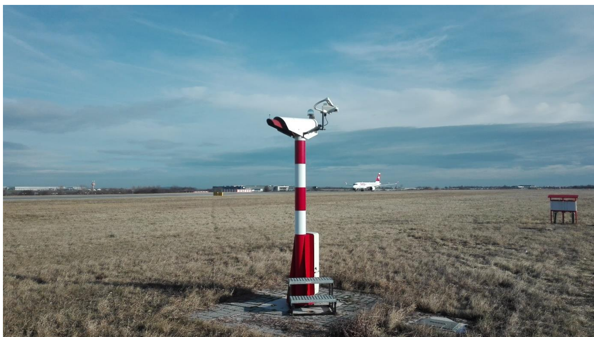
Vysílač transmisometru LT31 v poloze TDZ RWY24 na letišti LKPR
