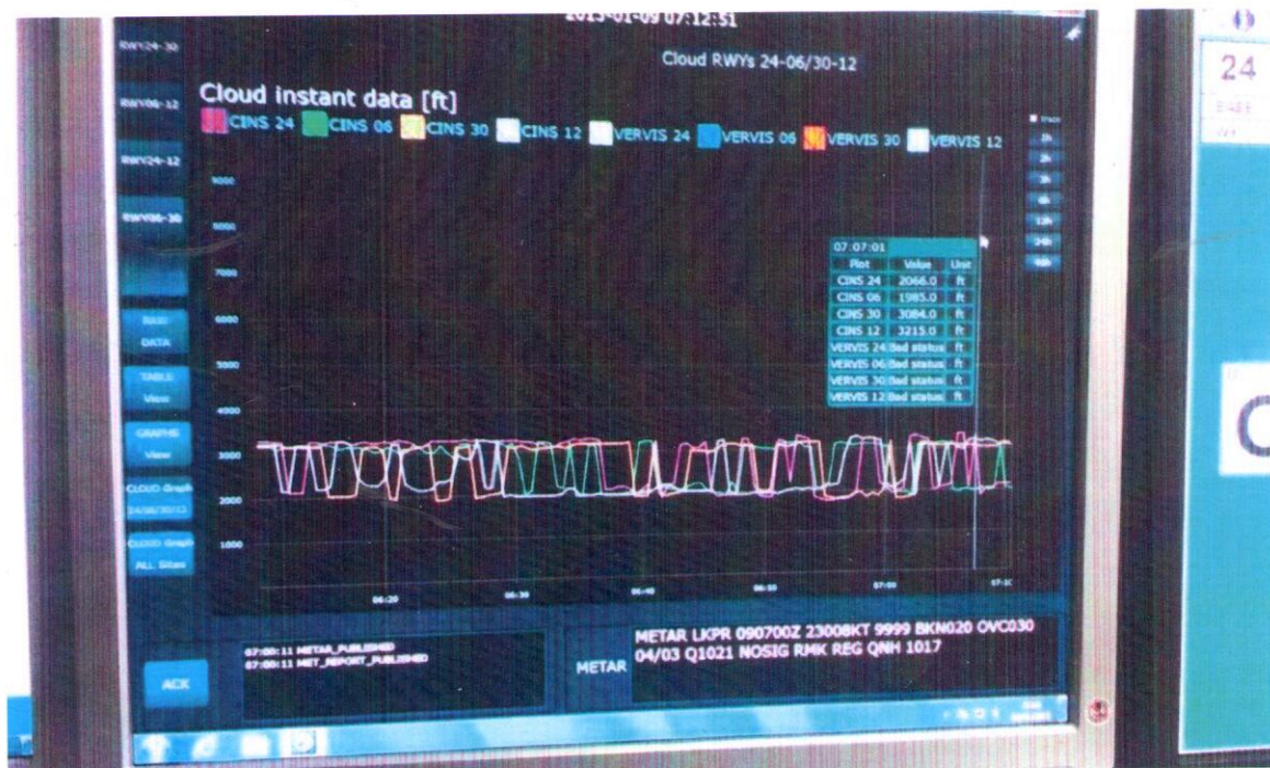
Obrazovka pracovní stanice systému AWOS na letišti Praha/Ruzyně s grafem vývoje výšky oblačnosti
