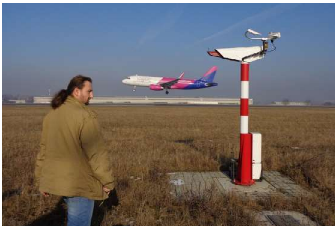
Vedoucí letecké meteorologické stanice letiště Praha/Ruzyně Bc. Pavel Pačes při kontrole transmissometru LT 31 (Vaisala) na MID RWY24
