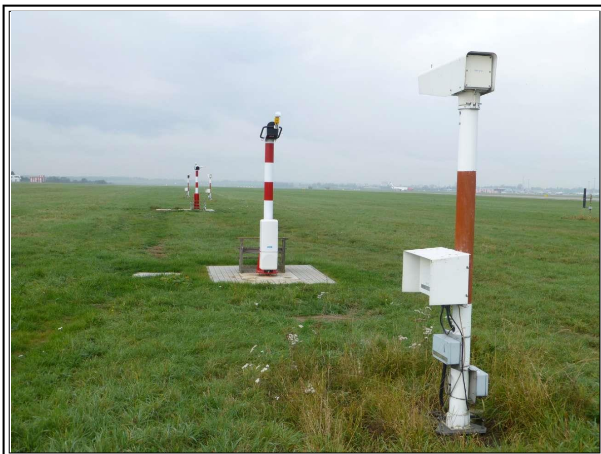
Transmisometr MITRAS single base (vpravo) a nový typ transmisometru LT31 (vlevo) vedle sebe na letišti v Praze/Ruzyni, pozice MID RWY30 (foto: Ing. Petr Černý)
