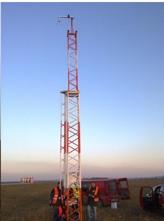
Ultrasonické anemometry WMT702, které nahradily klasické anemometry WAAWAV151 v pozicích TDZ RWY11 a TDZ RWY29 na letišti Karlovy Vary
