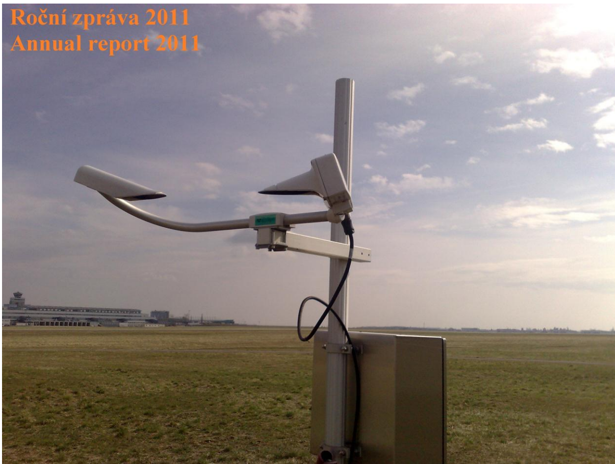
Měřič dopředného rozptylu PWD22 umístěný na měrném pozemku letecké meteorologické stanice na letišti Praha/Ruzyně Forwardscatterometer PWD22 located at the MET garden of the aeronautical METstation at the Praha/Ruzyně airport
