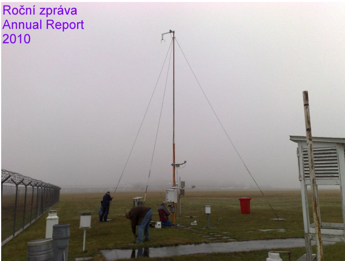
Výměna klasického anemometru za ultrasonický WMT702 na letišti Praha/Ruzyně (viz str. 12) Exchange of the classic anemometer for ultrasonic type WMT702 at the Praha/Ruzyně airport (see page 12)
