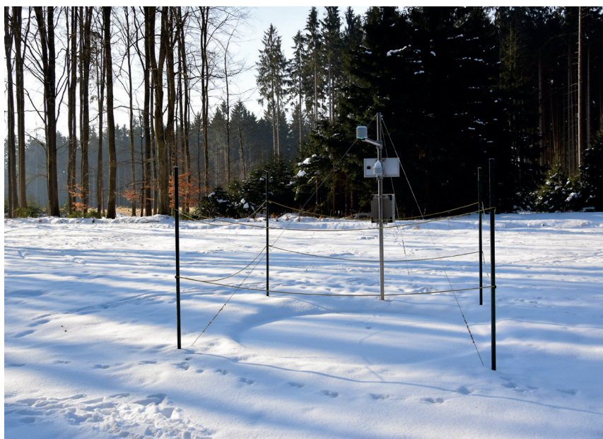
Obr. V.9 Automatická sněhoměrná stanice se senzory měřícími hydrostatický tlak v polštáři naplněném směsí nemrznoucí kapaliny a vody. Lokalita: Polánka v Křemešnické vrchovině. Fig. V.9 An automatic snow station with sensors which measures hydrostatic pressure in pillow which is filled up with a mixture of antifreezing liquid and water. Locality: Polánka in the Křemešnická vrchovina Highland.
