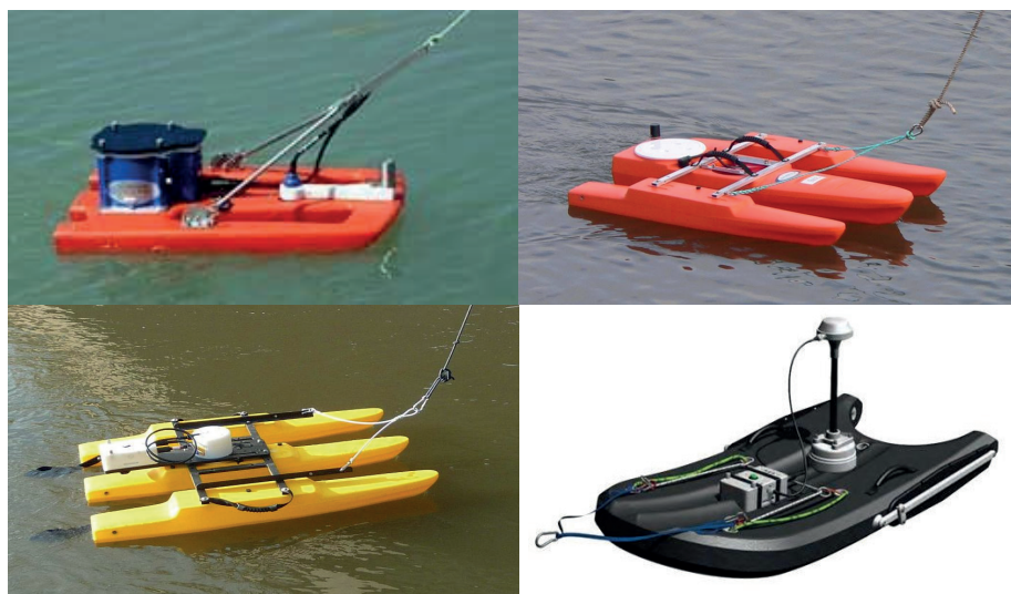
Obr. V.18 ADCP přístroje používané v ČHMÚ. Nahoře zleva: TRDI Stream Pro a TRDI Rio Grande; dole zleva: SonTek M9 upevněný na trimaranu a SonTek M9 RiverSurveyor na Hydroboardu. Zdroje: http://www.teledynemarine.com/rdi/ ; http://www.sontek.com .
