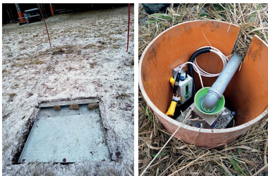
Obr. 2 Měření odtoku ze sněhu. A) Sněhový lysimetr pro sběr tající vody ze sněhu a B) Člunkový průtokoměr s datalogerem.
