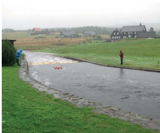
Obr. 6 Přetahování ADCP člunu při měření povodňového průtoku ( 8,9 \text{ m}^3 \cdot \text{s}^{-1} ) v profilu Jizerka, 7. 8. 2010.
