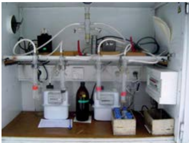
Obr. 141 Ukázka odběrových zařízení spadající pod Úsek kvality ovzduší ČHMÚ na stanici Červená hora (zleva: pluviokolektor, sekvenční vzorkovač pro odběr PM_{10} a stanice automatického měřicího programu s analyzátory pro hodnocení NO_x a O_3 ). Foto: ČHMÚ, 2015
