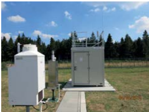
Obr. 141 Ukázka odběrových zařízení spadající pod Úsek kvality ovzduší ČHMÚ na stanici Červená hora (zleva: pluviokolektor, sekvenční vzorkovač pro odběr PM_{10} a stanice automatického měřicího programu s analyzátory pro hodnocení NO_x a O_3 ). Foto: ČHMÚ, 2015
