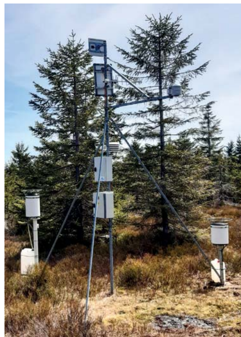
Obr. 1 Meteorologická stanice Rozmezí v Jizerských horách (995 m n. m.). Vlevo váhový srážkoměr MW7. Uprostřed automatická sněhoměrná stanice s ultrazvukovým čidlem na měření výšky sněhu. Vpravo člunkový srážkoměr MR3.
