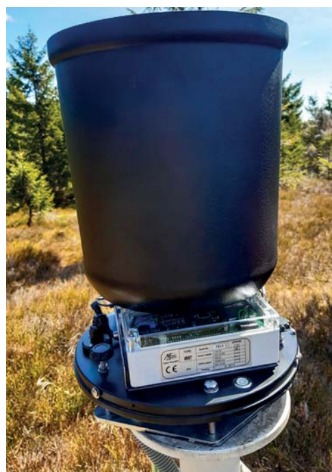
Obr. 2 Váhový srážkoměr Meteoservis MW7 v detailu: bez vnějšího ochranného pláště. Dole řídicí jednotka s váhou, na ní sběrná nádoba s čerpadlem.
