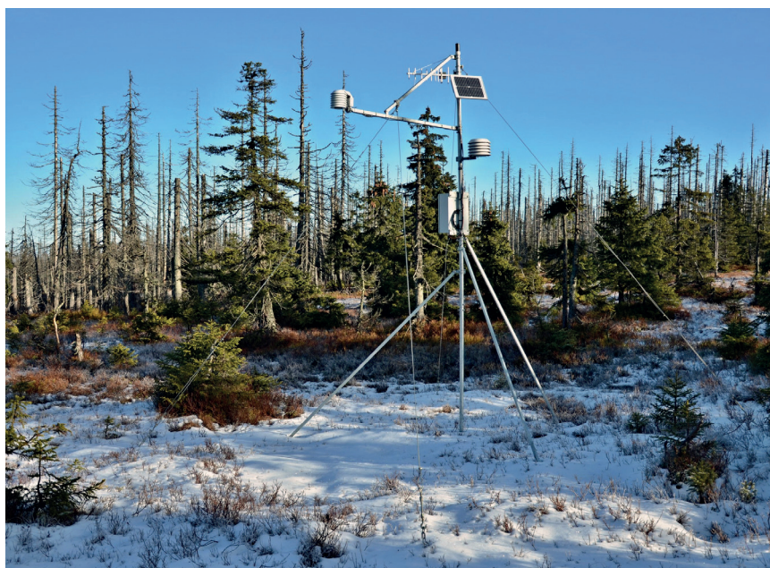
Obr. V.10 Automatická sněhoměrná stanice měřící výšku sněhové pokrývky pomocí ultrazvukového čidla. Lokalita: Plechý na Šumavě.
