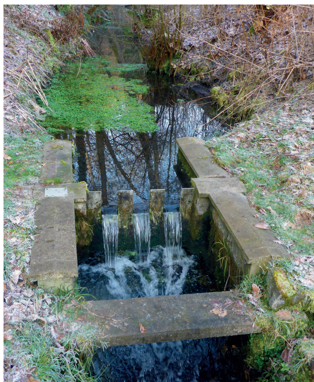
Obr. V.5 Pramen PP0237 Košátky s Ponceletovým přelivem o šířce 40 cm (vlevo), pramen PP0230 Kovář s obdélníkovými výřezy o šířce 10 cm (vpravo).
