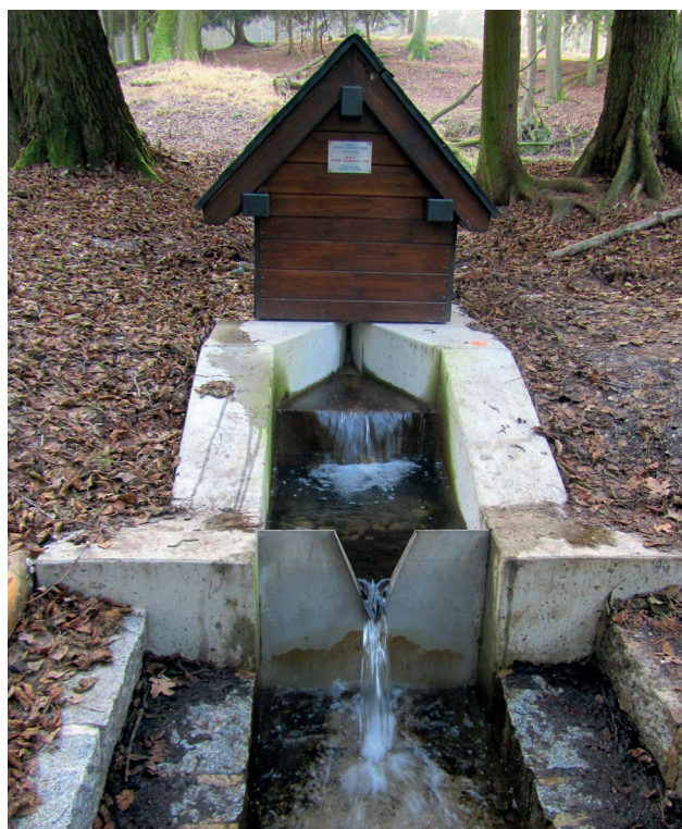
Obr. V.7 Pramen PP0197 Dolánky s Parshallovým žlabem typ P3 (vlevo), pramen PP0174 Mcely s Parshallovým žlabem typ P1 v kombinaci s trojúhelníkovým přelivem (vpravo).
