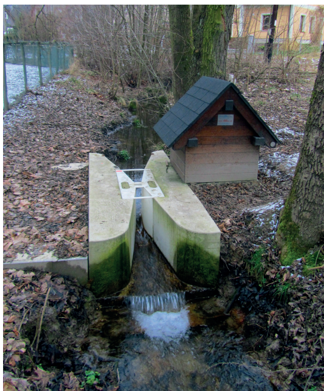
Obr. V.7 Pramen PP0197 Dolánky s Parshallovým žlabem typ P3 (vlevo), pramen PP0174 Mcely s Parshallovým žlabem typ P1 v kombinaci s trojúhelníkovým přelivem (vpravo).
