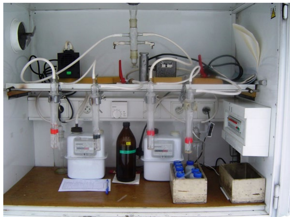
Ukázka historického odběrového zařízení pro měření koncentrací oxidu dusičitého (Foto: ČHMÚ, 2004).
