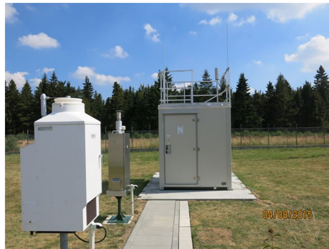
Ukázka odběrových zařízení spadající pod Úsek kvality ovzduší ČHMÚ na stanici Červená hora (Zleva: pluviokolektor, sekvenční vzorkovač pro odběr PM 10 a stanice automatického měřicího programu s analyzátory pro hodnocení NO x a O 3 ; Foto: ČHMÚ, 2015).
